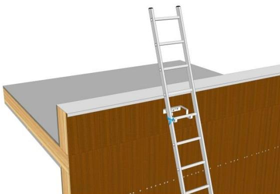
Abb. 3: LUX-top® LS III mit eingehängter Leiter
