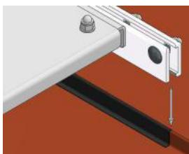
Montage auf Kupfer nur mit ST Quadrat erhältlichen EPDM - Streifen als Trennlage zulässig!
